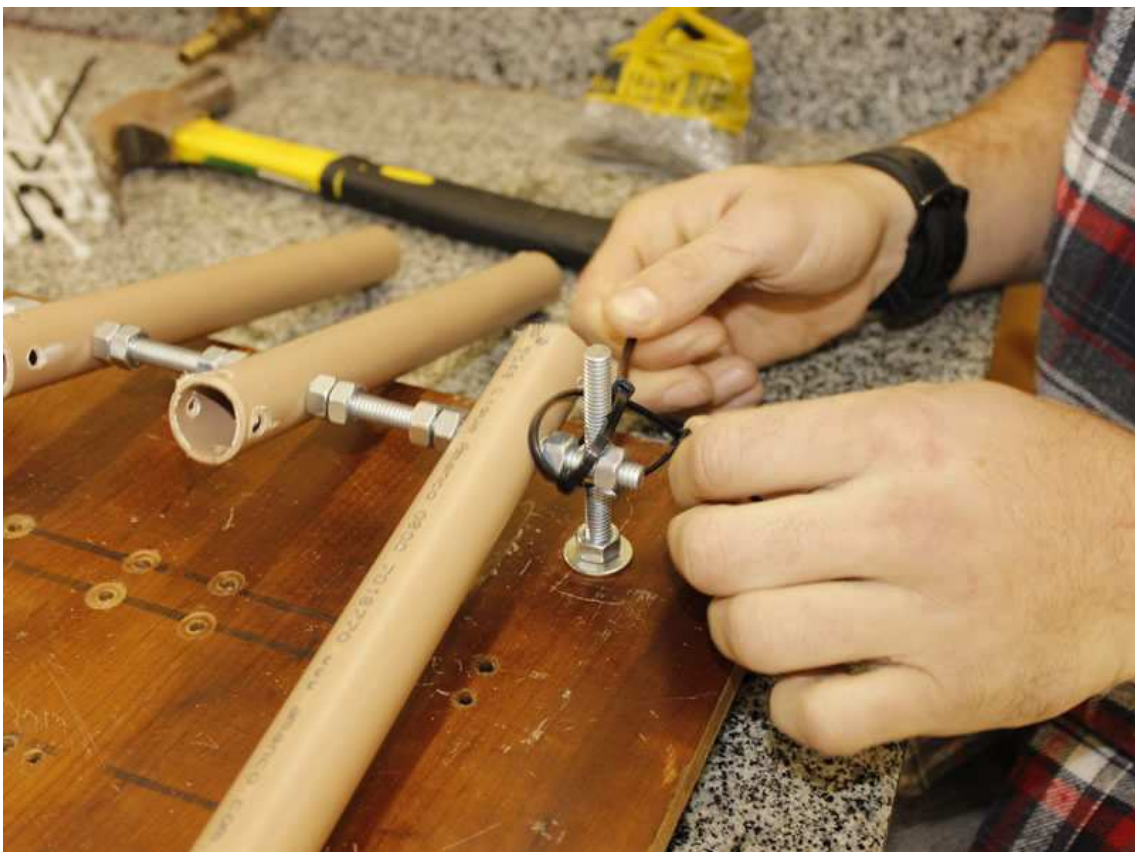
Fixe o eixo das alavancas com braçadeiras de nylon seguindo o exemplo. Figura 16
