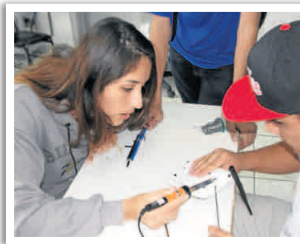
Os inventores soldam a antena em uma placa de circuito elétrico do roteador
